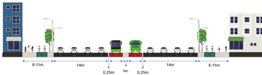
Perfil corredor sin estación desde la Cra. 50 hasta la Avenida Boyacá Fuente: DTP – IDU
