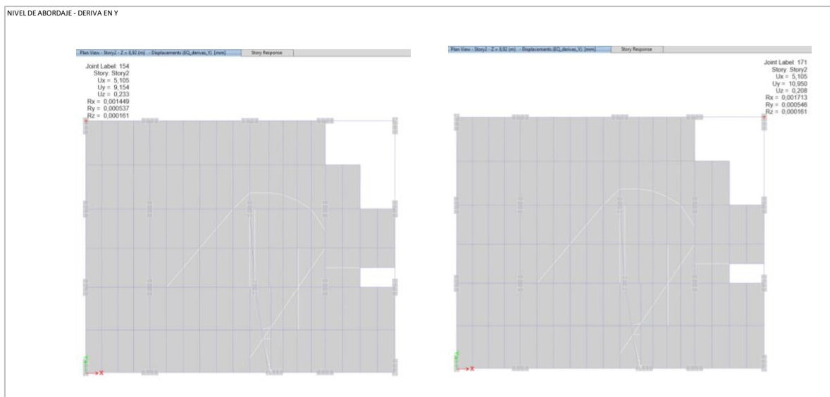
Figura 4.47 – Deformación para el sismo en Y a nivel de plataforma de abordaje.
